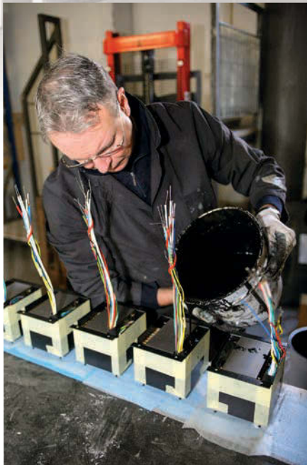
Handarbeit: Im Bild links werden die Trafos von Hand vergossen, während im Bild unten das Holz für die Frontplatte glattgeschmirgelt wird
