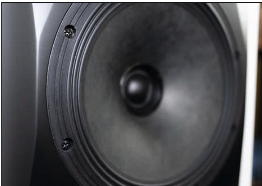
Die Gummisicke wurde so angepasst, dass sie besser linear auslenkt und damit Beugungsverzerrung der Hochtönerwellenausbreitung minimiert
